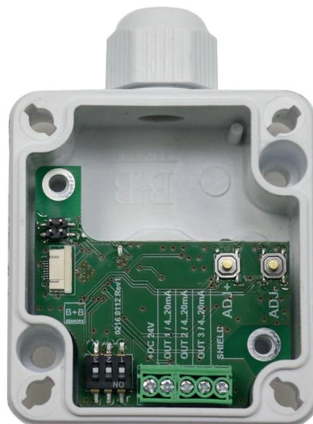
Die Abschirmung (SHIELD) ist optional zu belegen. Anschluss über geschirmte Leitungen ist zu empfehlen.
