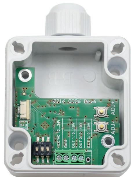
Die Messung des Ausgangssignals sollte mit separater Signalmasse erfolgen, um Messfehler durch Spannungsabfall an der Versorgungsmasse zu vermeiden.
