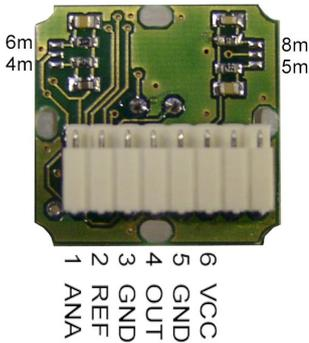
Auf der Rückseite des Moduls befinden sich vier Lötbrücken. Durch schließen (überlöten) einer der Brücken wird die Empfindlichkeit des Moduls herabgesetzt.
