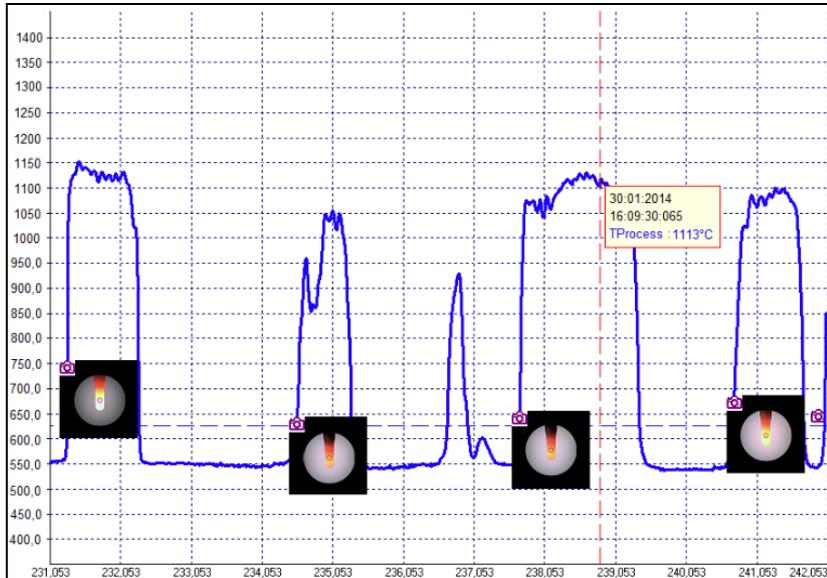
**Temperatur-Zeit-Diagramm mit automatischen Schnappschüssen – durch Mausklick auf das jeweilige Fotosymbol wird eine Bildvorschau im Diagramm angezeigt; mit Doppelklick kann der Schnappschuss im Vollbildmodus geöffnet werden.**
