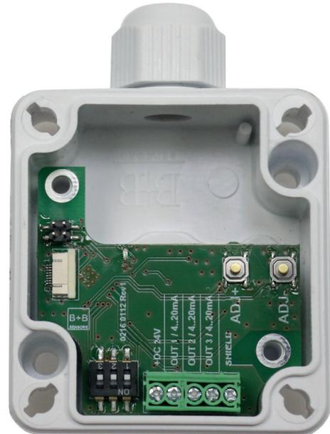
Die Abschirmung (SHIELD) ist optional zu belegen. Anschluss über geschirmte Leitungen ist zu empfehlen.
