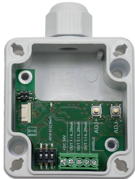
Die Abschirmung (SHIELD) ist optional zu belegen. Anschluss über geschirmte Leitungen ist zu empfehlen. Betriebsspannung +DC 16 ... 24 V ist für beide Messwandler gemeinsam.
