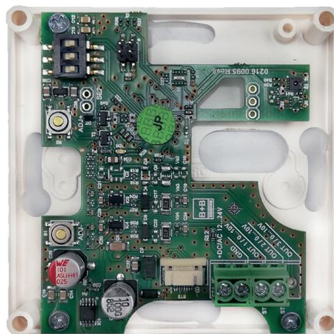
Die Messung des Ausgangssignals sollte mit separater Signalmasse erfolgen, um Messfehler durch Spannungsabfall an der Versorgungsmasse zu vermeiden.
