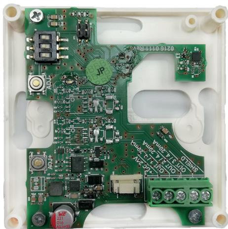
Die Abschirmung (SHIELD) ist optional zu belegen. Anschluss über geschirmte Leitungen ist zu empfehlen.
