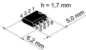
SO8 Gehäuse (150 mil, Standard SMT Technologie, SOIC-8) nach IEC 191-2Q: Type 076E35 B
